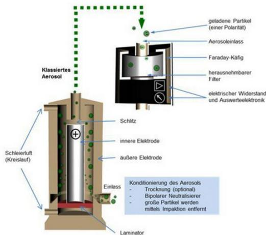
Abb. 1: Funktionsprinzip des Universal Scanning Mobility Particle Sizers (U-SMPS)
